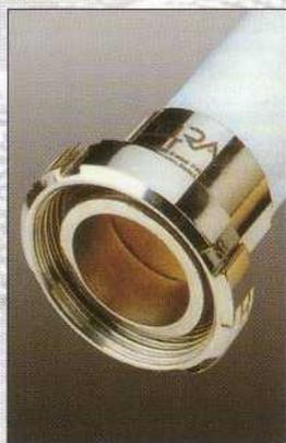
Accoppiamento fisso tra tubo e girella e fra tubo e ghiera. Montaggio e smontaggio a mezzo accoppiamento filettato DIN 405.
