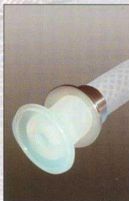
Attacco TC in silicone completo di guarnizione di tenuta; viene vulcanizzato con soluzione di continuità all'esterno del tubo di silicone. Una sottile guaina inox scorrevole sul tubo ed esterna all'attacco, irrigidisce il pezzo speciale e ne completa l'accoppiamento.
