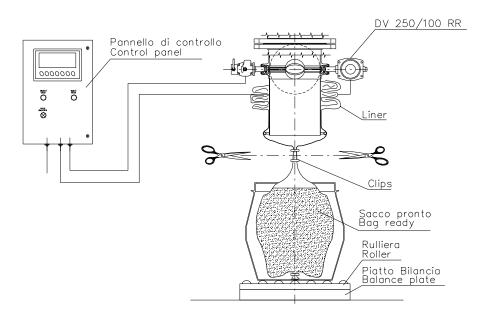
Esempio di composizione tipo: In questo caso il cliente ha richiesto un sistema fisso. Composition example: in this case the customer requested a fixed system.
